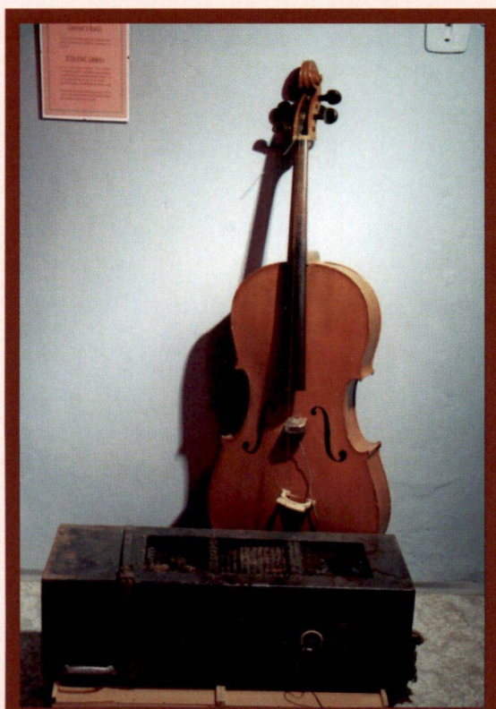
Violoncello Pavla Chrástiny. Zvuk snímala gramofonová přenoska jehlou zabodnutou do ozvučnice. V popředí 120W zesilovač SAMUEL, který dal jméno poděbradské skupině „S“. Dílo ing. Doležala a ing. Kaplana.
